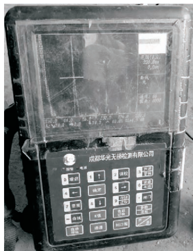
图13 缓冲杆堆焊后超声探伤检测 [42]
