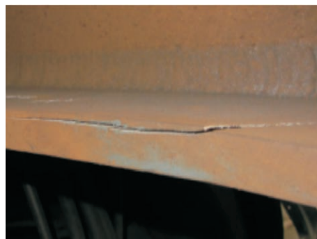
a 缓冲梁下盖板的板材分层 [13]
