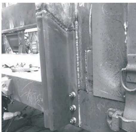
图22 C70货车侧柱截换 [62]
